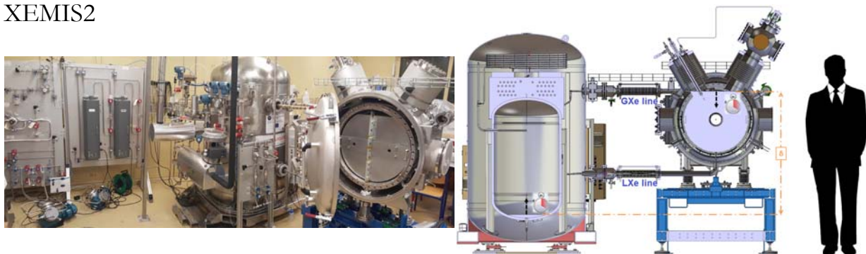
Figure 33 : - à gauche : photographie de la caméra XEMIS2 et de son infrastructure cryogénique xénon liquide dans les locaux de Subatech - à droite : schéma du principe des vases communicants entre l'unité ReStoX et le cryostat de XEMIS2
