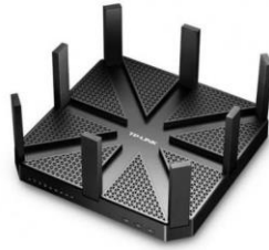
Figure I- 93: Routeur WIFI intégrant le standard 802.11.ad
