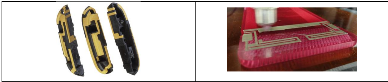
Figure II- 23: Antenne à partir de la technologie LDS
