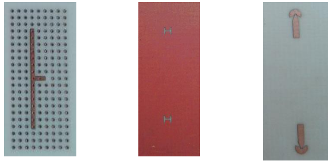
Figure III- 31: Résonateur simple stub en gap waveguide
