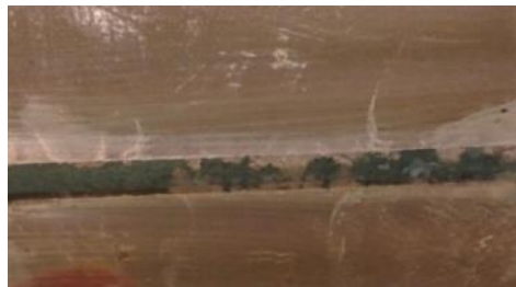
Figure III- 65: Ligne microruban, contaminée avec du NaCl, puis exposée à 97 % d'humidité
