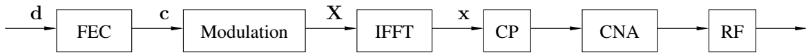
FIGURE 4.2 – Schéma de transmission et de réception de base pour la modulation OFDM
