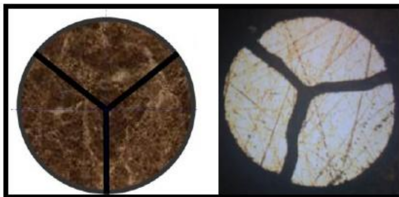
Figure 2.20 : Vue d'ensemble d'une sonde triple : a) Idéale ; b) sonde triple réelle utilisée dans notre dispositif (Berrich, 2011)
