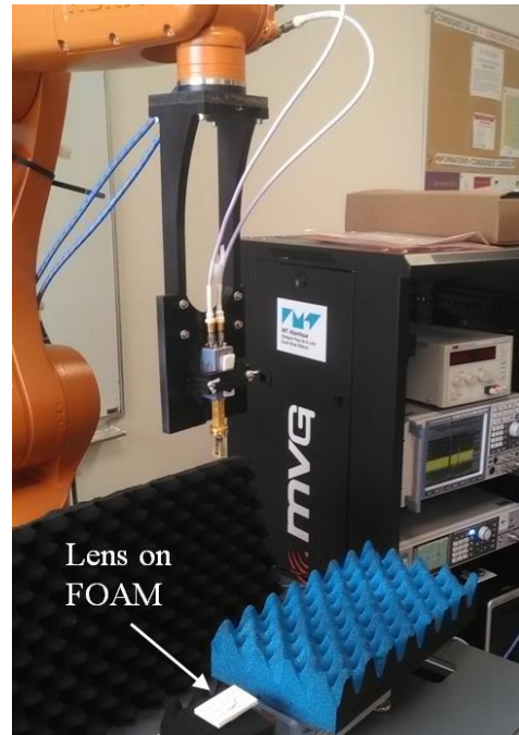
Figure 8. Banc de mesure robotisé
