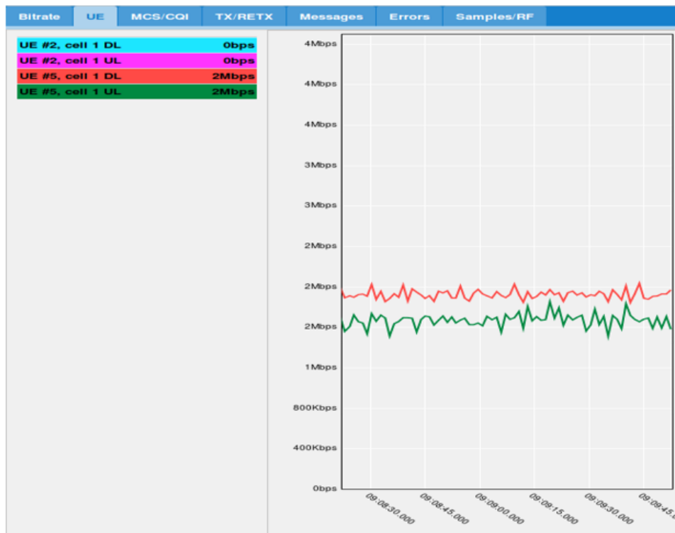
FIGURE 16 – Débit UL / DL du service XpertEye™ pour le cas de test 1
