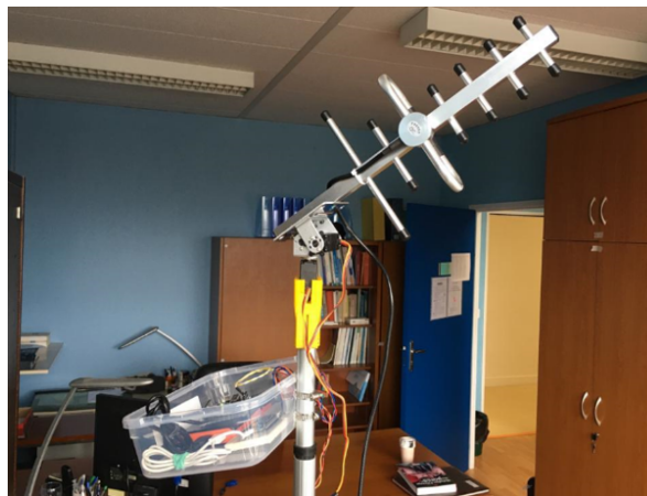
FIGURE 7 – Antenne YAGI sur perche télescopique contrôlée par microcontrôleur
